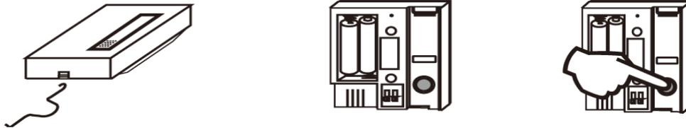
Ouvrez d'abord le couvercle à l'aide du clip fourni, puis faites glisser l'interrupteur ON/OFF sur OFF. Appuyez ensuite sur le bouton ON/OFF de manière continue et mettez simultanément l'interrupteur à glissière ON/OFF sur ON, continuez à appuyer sur le bouton pendant cinq secondes jusqu'à ce que la LED clignote cinq fois. Un nouveau code a maintenant été généré.
